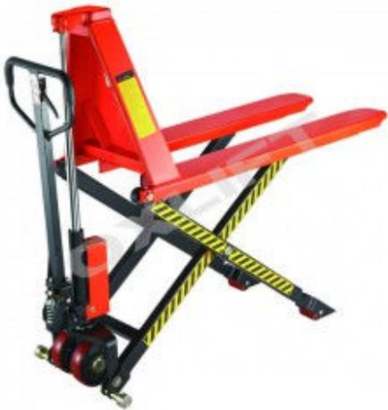
Гидравлическая тележка с ножничным подъемом отличается от стандартной рохли тем, что она способна поднимать вилы с грузом на высоту до 800 мм (вместо 200 мм для стандартной рохли), а это позволяет перемещать грузы не только по горизонтали, но и по вертикали, что существенно облегчает и ускоряет погрузочно-разгрузочные работы. Сочетание высоты подъема 800 мм с грузоподъемностью 1000-1500 кг достаточно для работы с большинством грузов.
